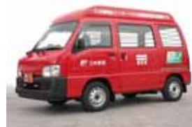
ガソリン車の改造電気自動車
