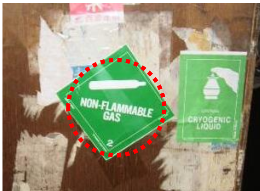
危険物ラベル(ガス類:非引火性、非毒性)の貼付
